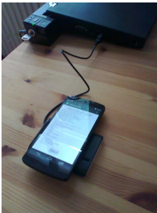
Abbildung 7: Das Smartphone auf dem Kartenleser emuliert eine Smartcard.
