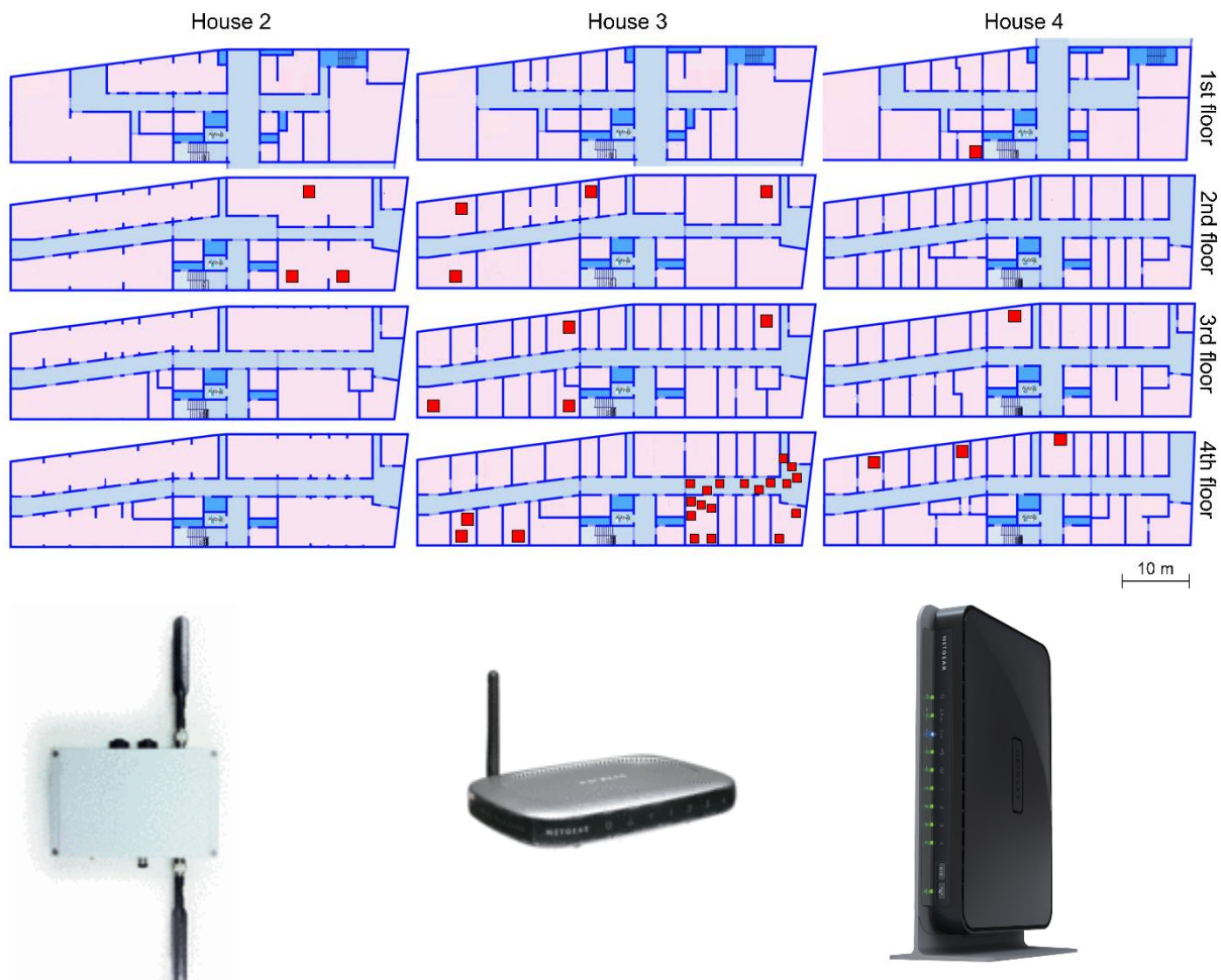
Abbildung 5: Das Humboldt Wireless Lab umfasst 4 Etagen von 3 Gebäudeteilen. Es besteht aus 3 verschiedenen Geräten (Seismo, WGT634u, WNDR3400).
